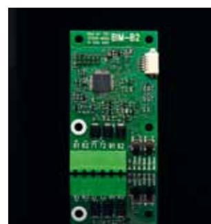
I moduli di interfaccia BIM Biral consentono di integrare in maniera semplice e intuitiva la propria pompa in tutti i tipi di condutture degli edifici, rispondendo alla situazione odierna ma anche a eventuali modifiche future.
